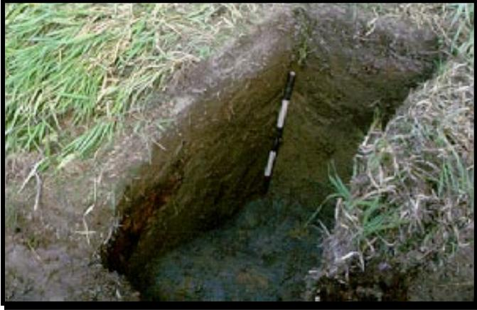
Figure 8 Argiles stériles dans le fond d'un sondage.
