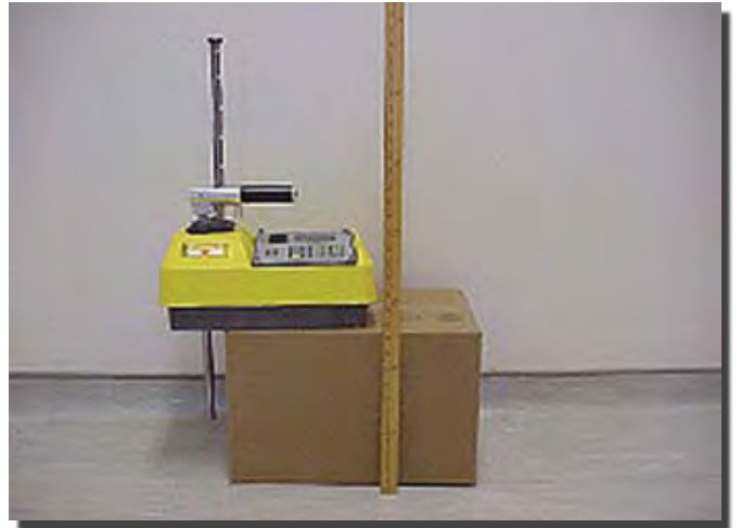
Figure 8. Jauge nucléaire portative de type Troxler dont la source (de type « crayon ») est sortie
