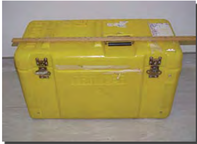
Figure 5. Colis du type A contenant une jauge nucléaire portative de type Troxler
