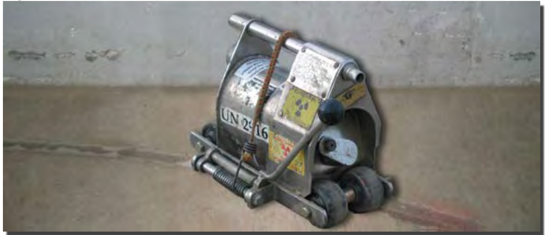
Figure 33. Appareil d'exposition Pneumat-A-RAY
