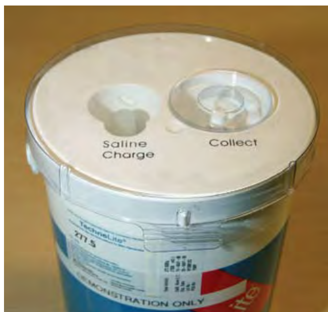
Figure 15. Source de molybdène radioactif. Vue de dessus du générateur de technétium 99 m
