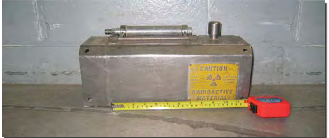
Figure 26. Appareil d'exposition SPEC 150
