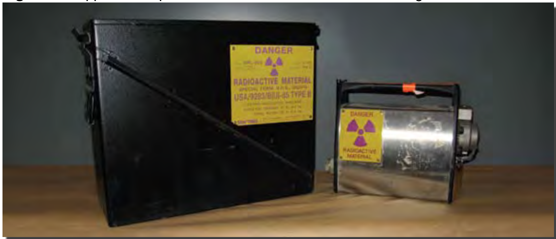
Figure 30. Appareil d'exposition Sentinel 660B avec suremballage OPL 660
