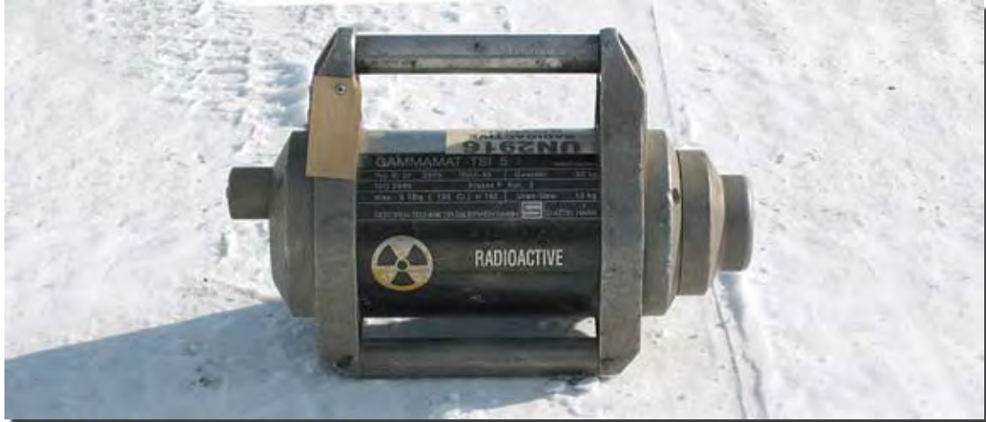
Figure 35. Appareil d'exposition Gammamat TSI5
