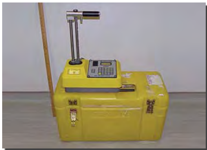
Figure 7. Jauge nucléaire portative de type Troxler dont la source (de type « crayon ») est en position blindée
