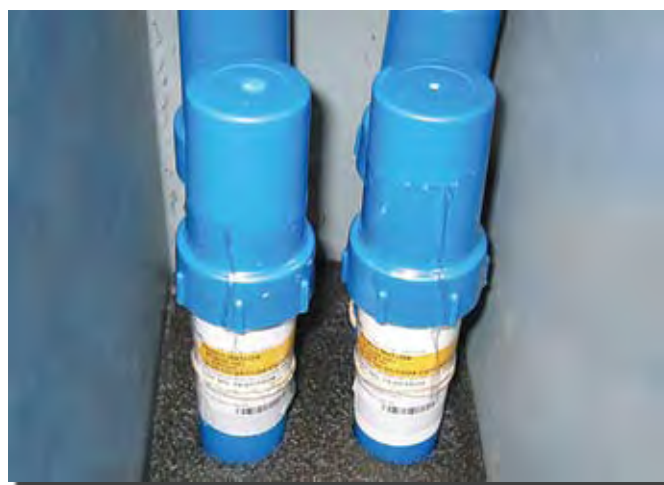
Figure 20. Unités de dose de technétium 99 m, contenues dans le colis de la figure 18. L'emballage bleu est revêtu de plomb et transporte des seringues qui contiennent habituellement entre 1 et 3 ml de matières radioactives — probablement du technétium 99 m sous forme liquide, ou du gallium 67.
