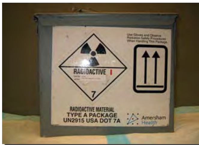
Figure 18. Colis du type A contenant des unités de dose de technétium ( ^{99m}\text{Tc} )
