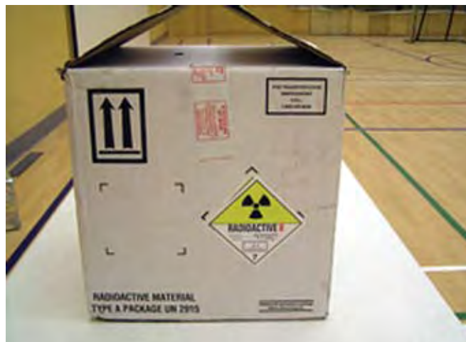
Figure 13. Boîte contenant un générateur de technétium (technétium 99 m ou 99mTc)
