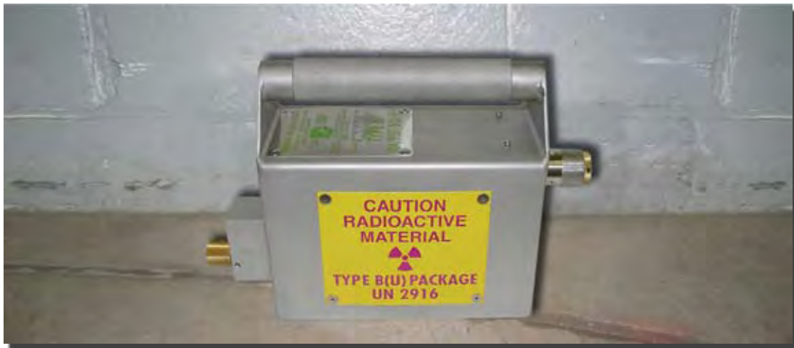
Figure 36. Appareil d'exposition IR-100
