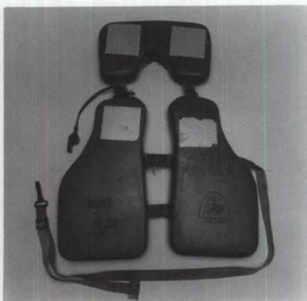
2.13 Une des brassières de sauvetage Billy Pugh modèle #200 récupérées. Sur la photographie, on ne voit pas l'ampoule activée par l'eau de mer dont chaque brassière est dotée.
