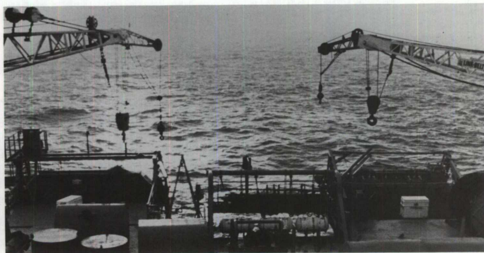
2.11 Arrière de l' Ocean Ranger et embarcations de sauvetage Harding (à droite) et Watercraft (à gauche). Un poste de radeaux de sauvetage comprenant trois contenants et un filet de sauvetage se trouve entre les deux embarcations. Les boîtes blanches à côté de chaque embarcation contiennent les brassières de sauvetage.
