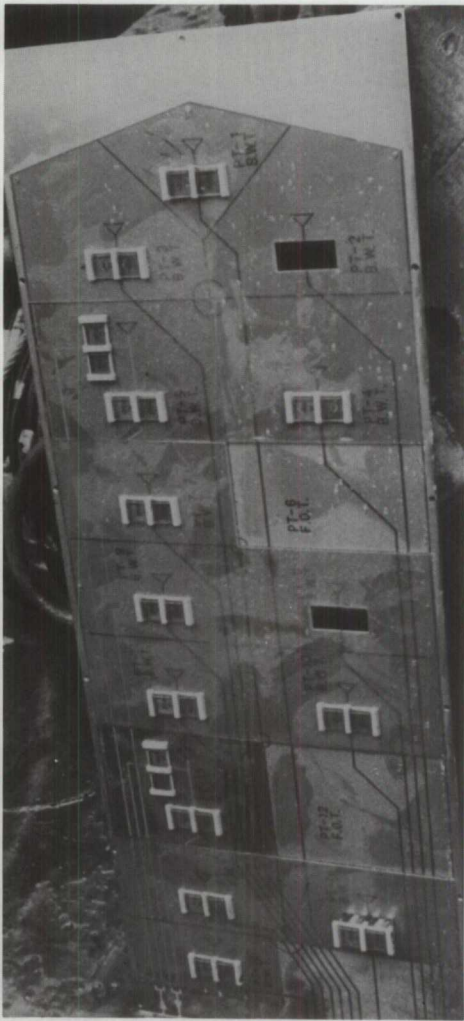
7.4 Une des quatre sections du panneau schématique récupérées de l'épave. Plusieurs dispositifs de mise en place en plexi-glass ont été enlevés et perdus pendant les travaux de récupération.
