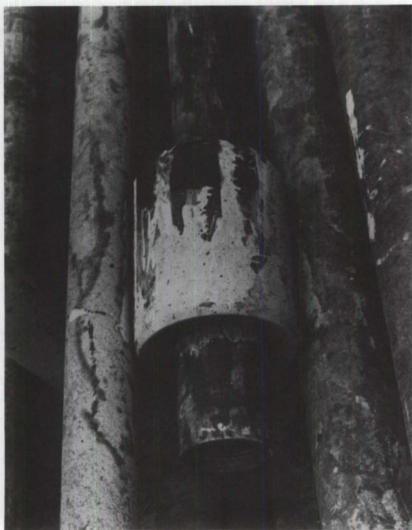
FIGURE 10 Outil de débranchement de l' Ocean Ranger . La partie inférieure cylindrique à grand diamètre en acier est conçue pour s'appuyer sur les mâchoires du bloc d'obturation
