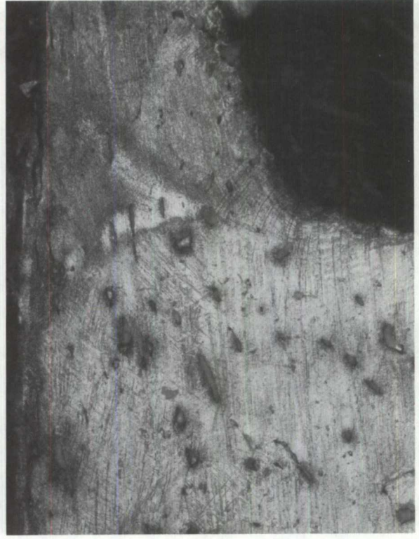
PHOTOGRAPHIE 17 Coupe transversale de la bague de blocage du hublot n° 4, présentant une forte concentration de lignes de glissement de déformation autour de la base de la lèvres protubérante.
