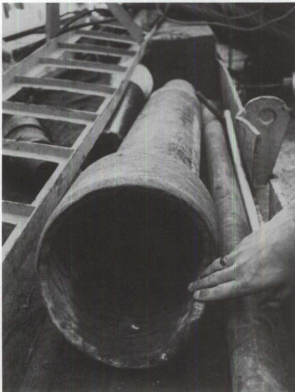
FIGURE 7 Fraise utilisée pour meuler l'extrémité cisillée de la tige de forage
