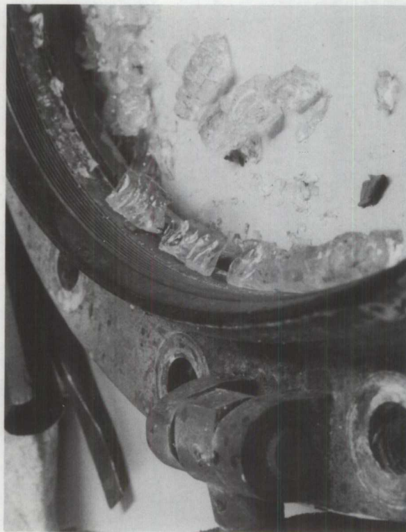
PHOTOGRAPHIE 11 Hublot n° 1, fragments de verre après dépose de la bague de blocage.
