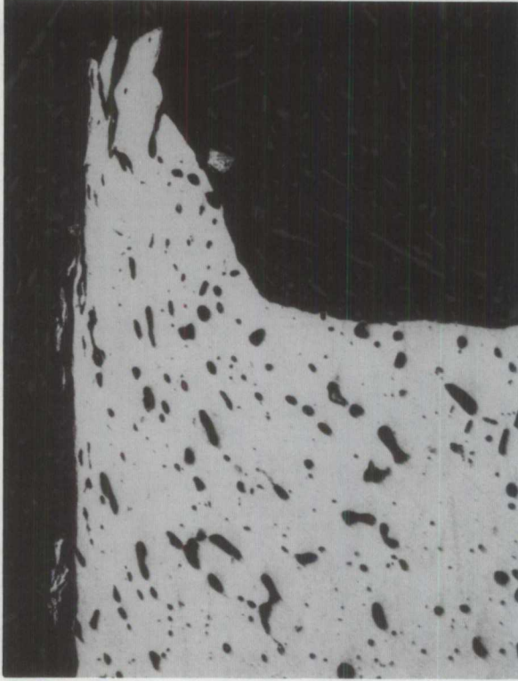
PHOTOGRAPHIE 11 Coupe transversale de la bague de blocage du hublot n° 4, présentant une lèvre protubérante similaire.
