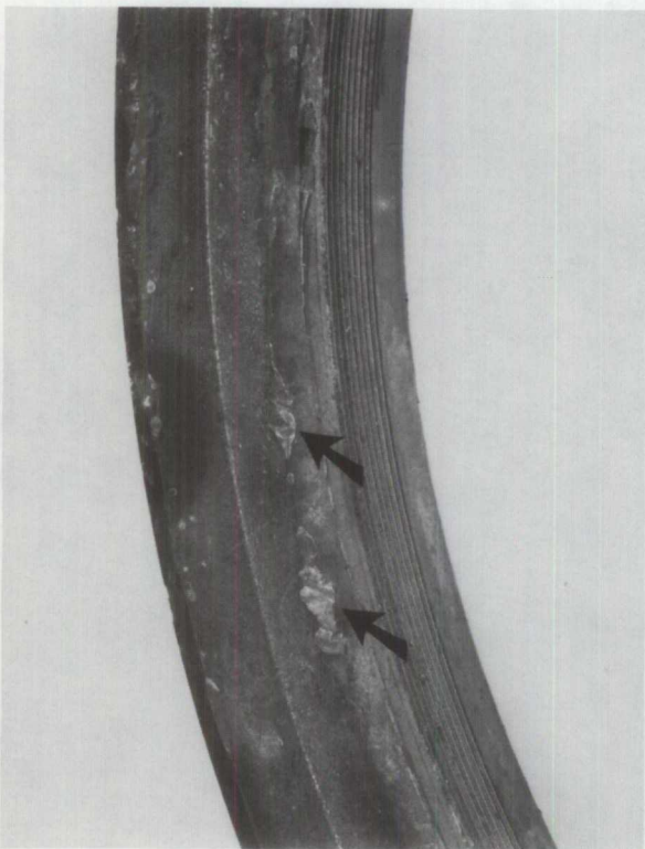
PHOTOGRAPHIE 10 Hublot n° 4, marques de coups et rainures (flèches) sur les bords externes du hublot.
