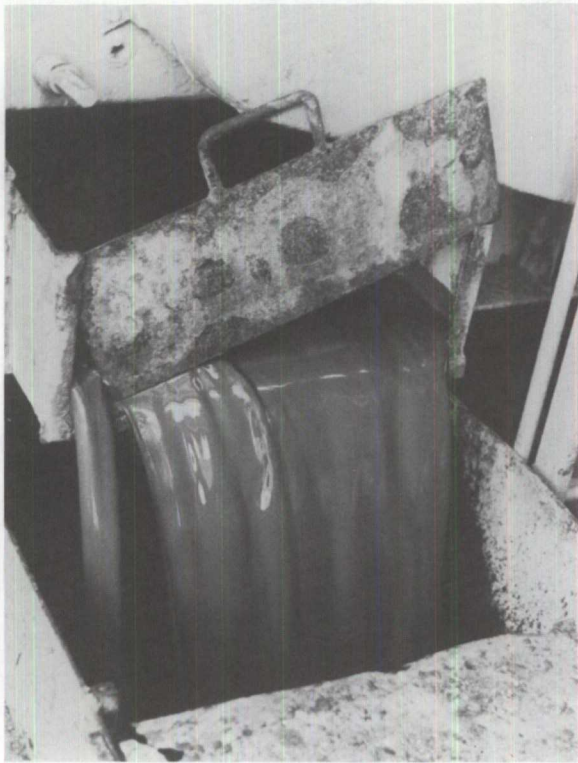
FIGURE 5 Fluide de forage pompé du puits J-34
