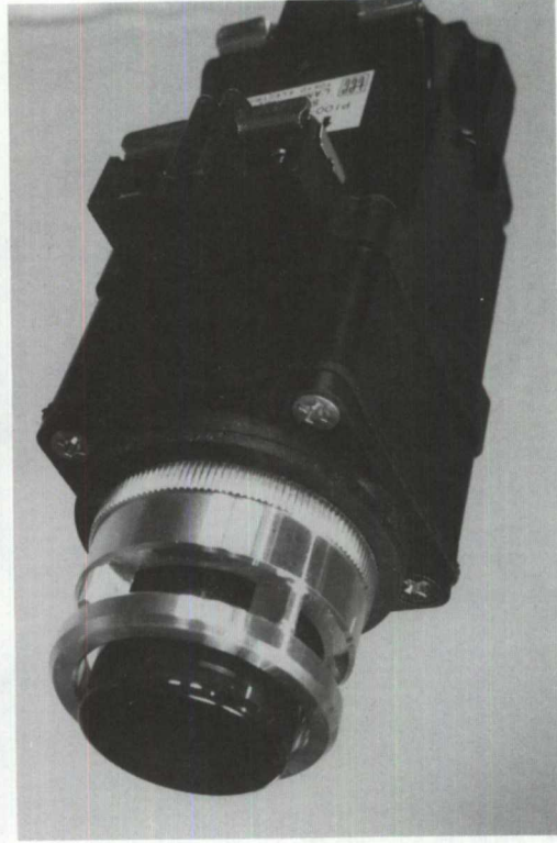
PHOTOGRAPHIE 12 Interrupteur de pompe «vert».
