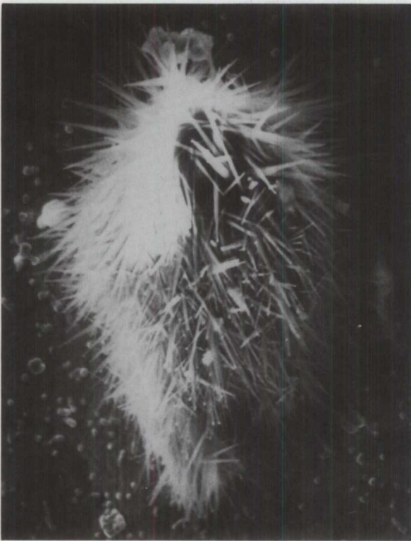
PHOTOGRAPHIE 5 Micrographie d'un groupe cristallin de composés de sodium entouré de minuscules cristaux de chlorure de sodium
