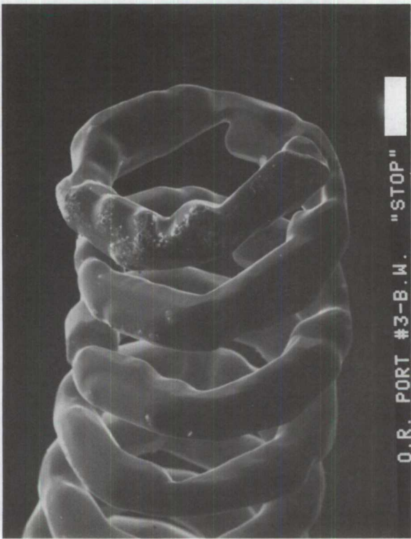
PHOTOGRAPHIE 6 Fracture régulière — Ampoule «arrêté» #3, pompe d'eau de ballast, bâbord.
