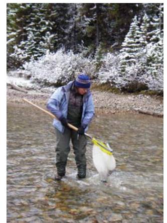
Échantillonnage d'invertébrés benthiques avec un filet troubleau dans un cours d'eau accessible à gué © Environnement Canada
