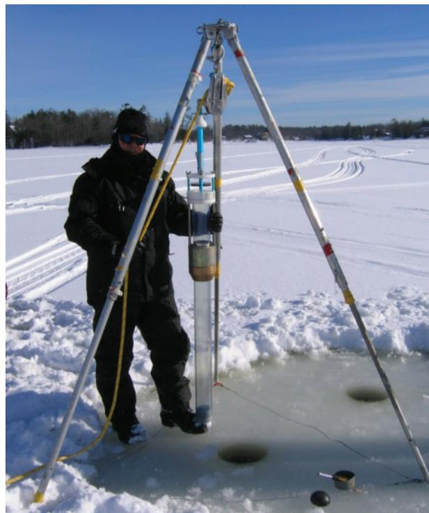
Prélèvement d'un échantillon de sédiments et d'eau sur la baie Georgienne gelée
