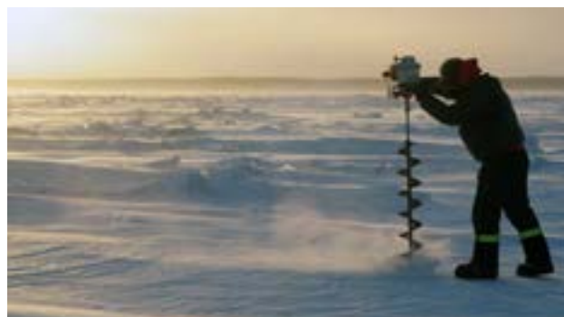
Un technicien en hydrométrie d'ECCC perce la glace du fleuve MacKenzie gelé pour mesurer le débit de l'eau sous la glace.
