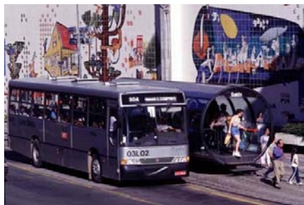
Le système de transport de Curitiba, exclusivement par autobus, est un modèle pour des villes partout dans le monde. Le bus rapide (« speedy bus ») occupe une ligne directe et ne s'arrête qu'à des stations tubulaires spécialement conçues pour accélérer le transport des passagers
