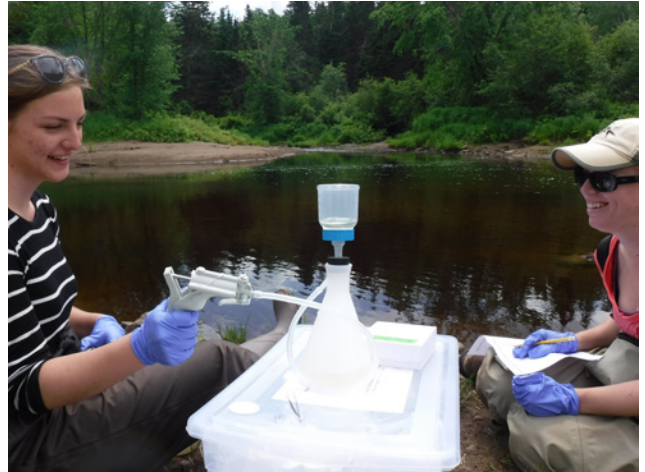
Photo : Prélèvement et filtration d'échantillons d'eau à des fins d'analyse (source : Southeastern Anglers)
