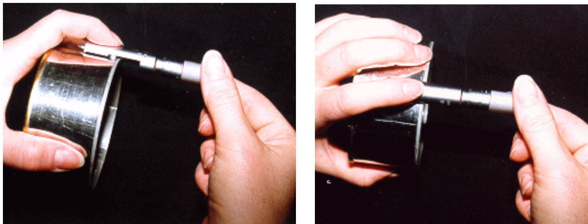
Figure 4.1.3.f - Mesure de la longueur du crochet de corps
