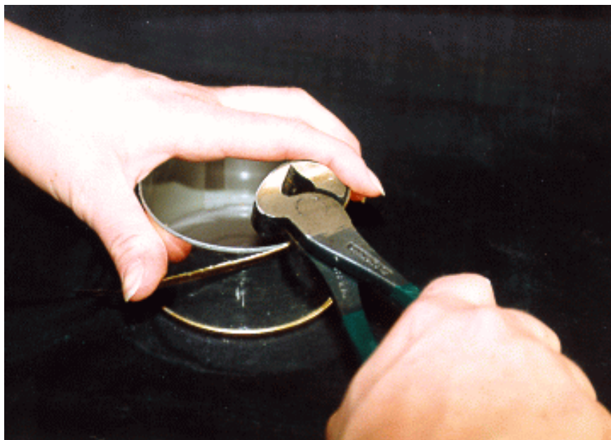
Figure 4.1.3.d - Dégagement de la partie restante du crochet de fond
