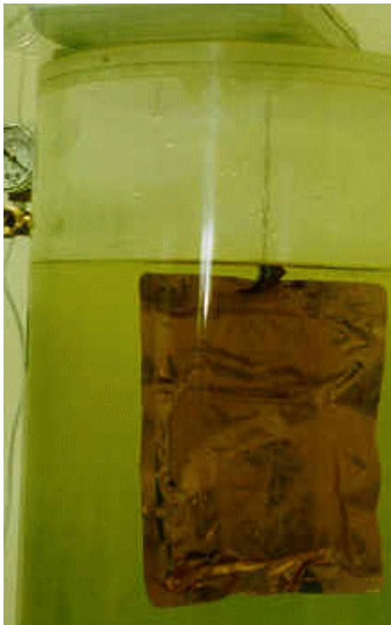
Figure 4.9 Pesée du sachet dans l'eau
