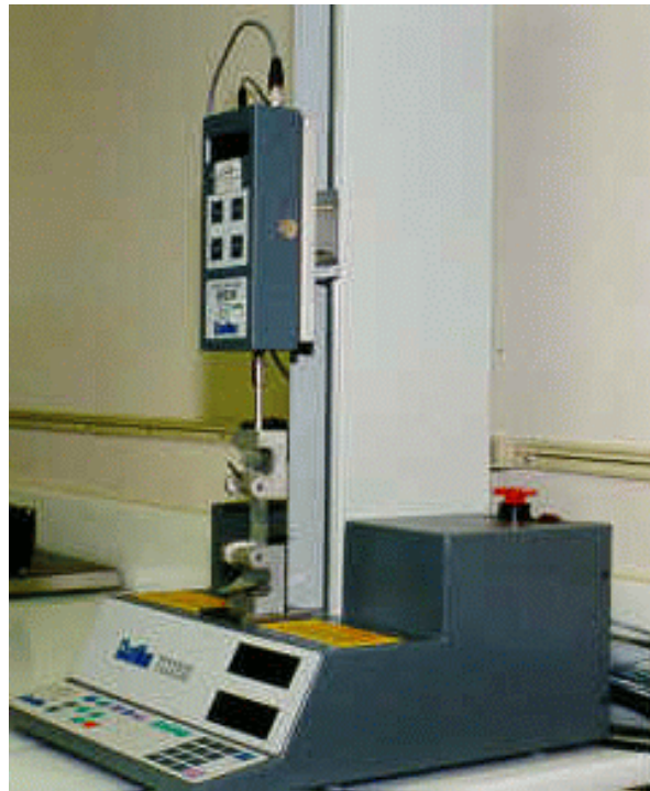
Figure 4.6 Appareil d'essai de traction, avec l'échantillon mis à l'épreuve
