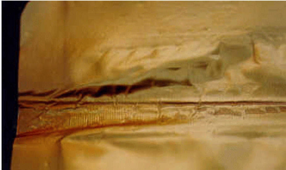
Séparation des couches et présence de bulles dans le produit laminé en polyester
