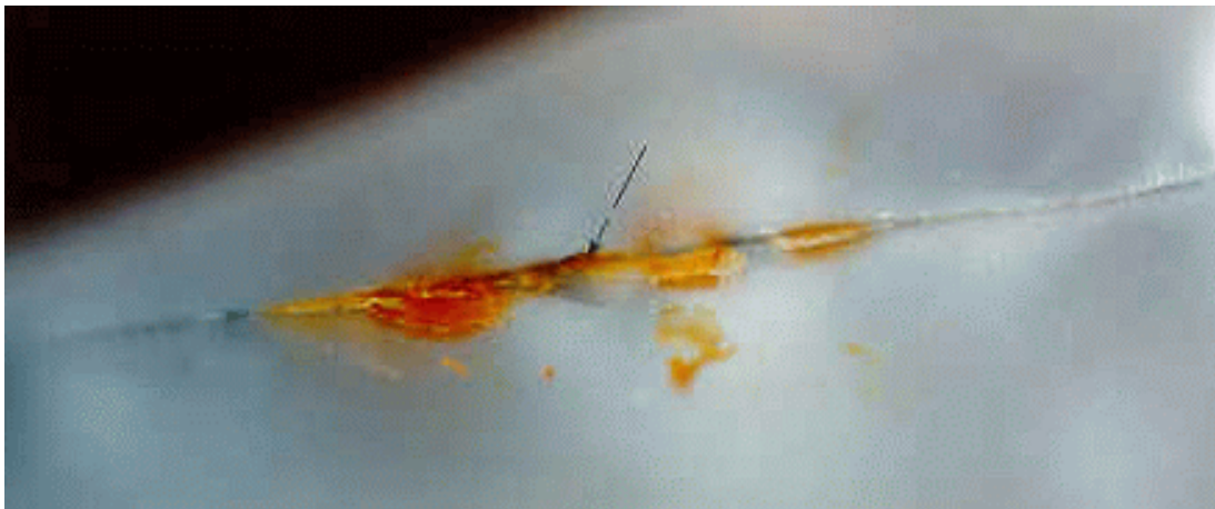
Canal de fuite vu de l'intérieur du sachet (la flèche indique le canal)
