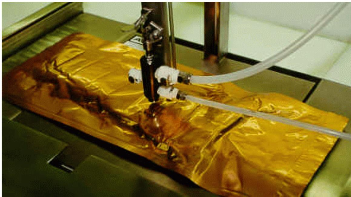
**Figure 4.3** Appareil d'essai d'éclatement sous pression interne - mise à l'épreuve de 4 soudures
